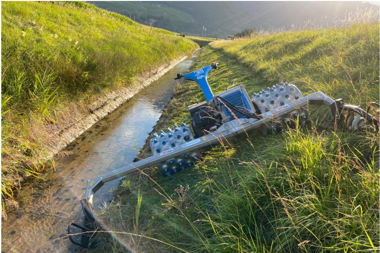
Fig. 9. La marque Brielmaier propose par exemple une motofaucheuse avec entraînement hydraulique parfaitement adaptée à l'entretien de talus pentus.
