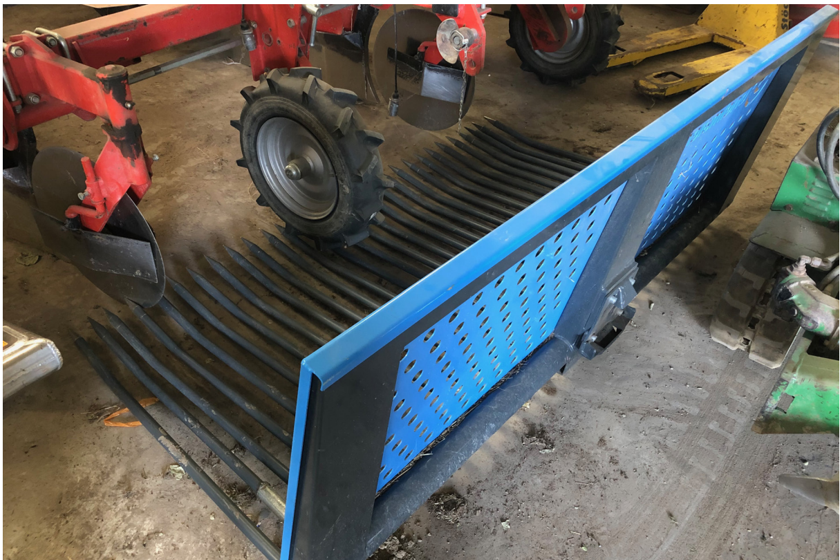
Fig. 10. Un peigne peut être adapté sur la machine afin de récupérer le matériel issu de la coupe. Ce dernier peut ensuite être récupéré ou disposé en tas.
