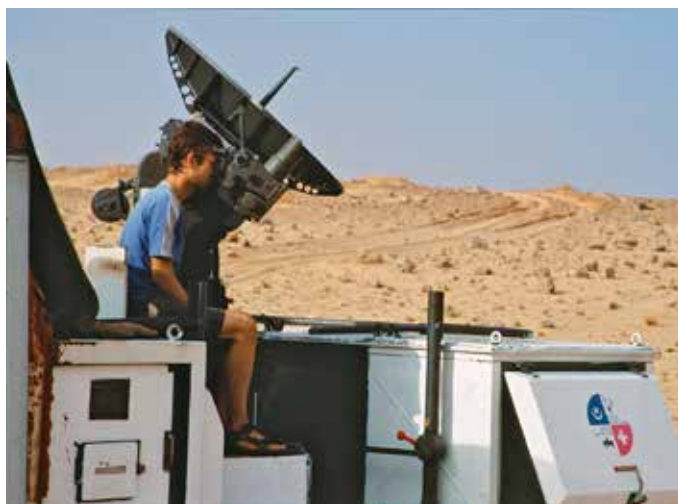
Der Radar erkennt Vögel sowohl im Dunkeln als auch in grossen Höhen. Diese Technik erlaubt es beispielsweise, die Höhenverteilung, die Flugrichtungen und Fluggeschwindigkeiten der Vögel zu messen.
