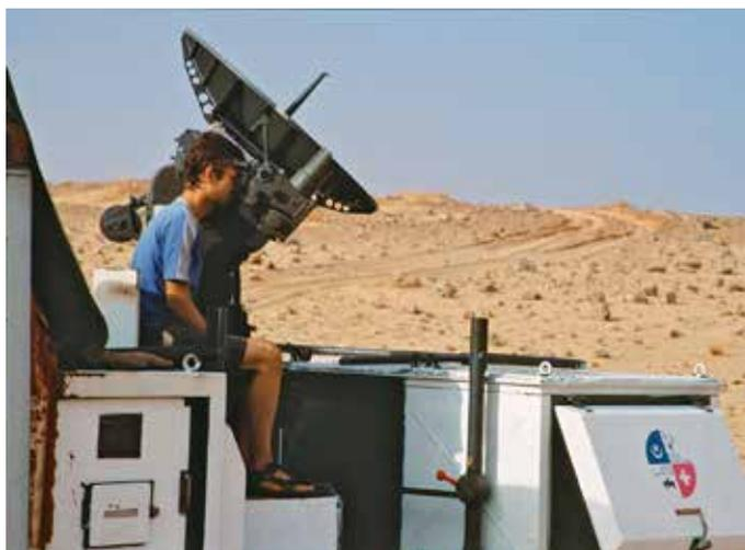
Le radar repère les oiseaux également dans l'obscurité et à des altitudes élevées. Cette technique permet par exemple de mesurer la répartition de la migration selon les altitudes et les directions et vitesses de vols des oiseaux.
