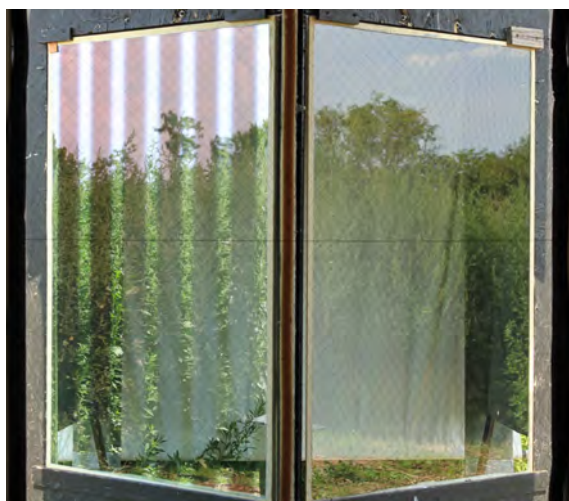
Tunnel de vol tel que l'oiseau le voit. Pilkington AviSafe™ vue extérieure : hautement efficace comme protection pour les oiseaux, à peine visible depuis l'intérieur.
