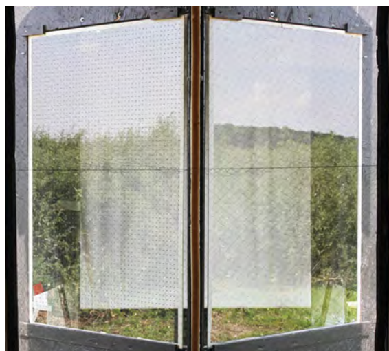
Malgré un faible espacement entre les points, cette trame est inefficace : le motif serré de points noirs de 3 mm de diamètre n'a pas été repéré par les oiseaux, y compris en position 1.
