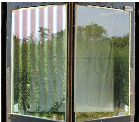
Cosa vede l'uccello nel tunnel di volo. Pilkington AviSafe™: altamente efficace come protezione contro le collisioni di uccelli, praticamente invisibile dall'interno (a sinistra lastra di prova, a destra lastra di riferimento).
