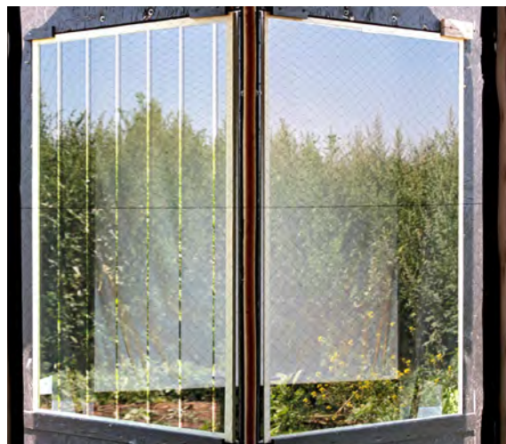
Arnold Glas Ornlux® design lines 5/95: marcatura metallica altamente efficace con classico motivo a strisce (a sinistra lastra di prova, a destra lastra di riferimento).
