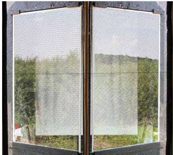
Reticolo di punti inefficace nonostante la piccola distanza tra i punti: anche un denso reticolo di punti neri con un diametro di 3 mm non è stato riconosciuto dagli uccelli neanche alla posizione 1 (a sinistra lastra di prova, a destra lastra di riferimento).
