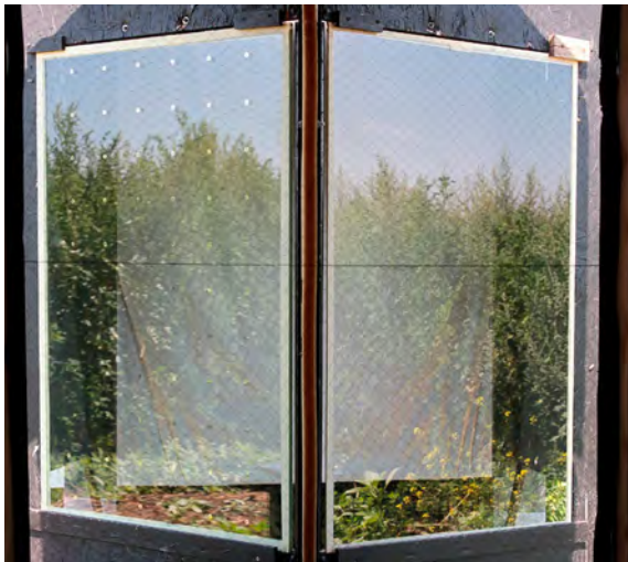
Eastman Saflex® FlySafe™ SEEN shiny 9/90: punti metallici con un diametro di 9 mm a una distanza di 90 mm: altamente efficaci e adatti anche per la posizione 2 grazie all'elevata riflettanza (a sinistra lastra di prova, a destra lastra di riferimento)..
